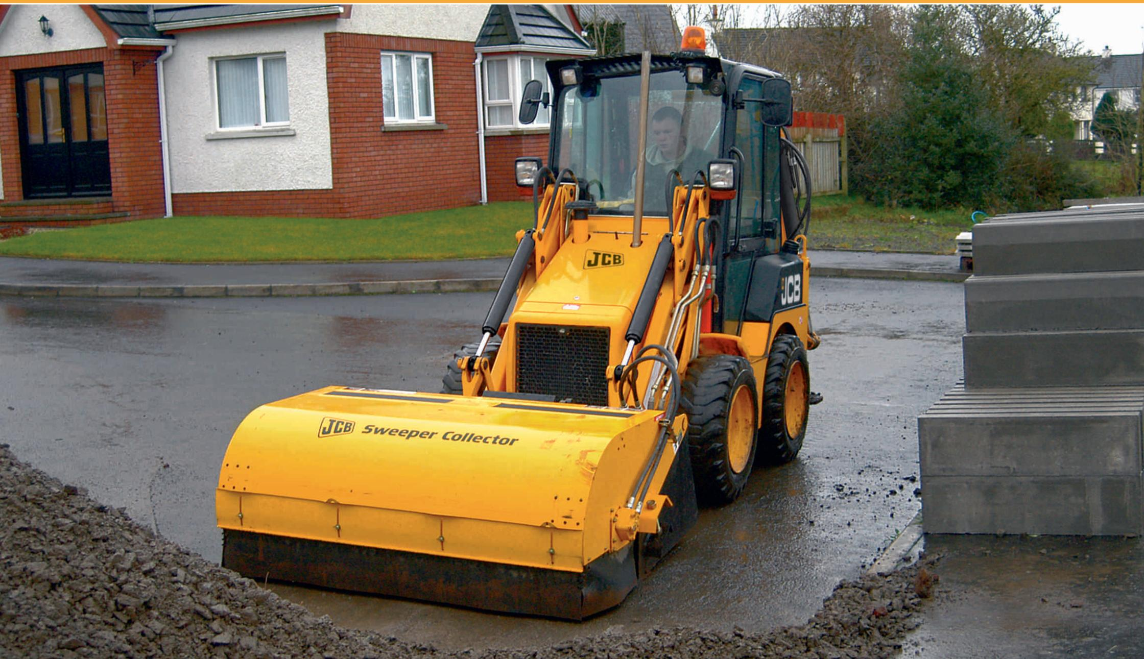
MÁXIMA POTÊNCIA DO MOTOR: 37.3kW (50HP) MÁXIMA PROFUNDIDADE DE ESCAVAÇÃO DA ESCAVADEIRA (BRAÇO PADRÃO): 2.55 metros MÁXIMA CAPACIDADE DE CARGA: 610kg
